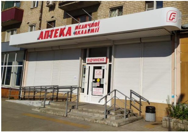
[ Вивіска в м.Павлоград. Матеріали: металевий каркас, композитний лист, с/к плівка, зовнішня підсвітка прожекторами на кронштейнах. ]
