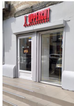
[ Вивіска в м.Дніпро. Матеріали: об'ємні букви з кольорового акрилу, металевий каркас, внутрішня підсвітка світлодіодною лентою. ]
