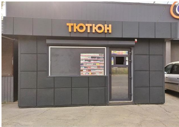
[ Вивіска в м.Дніпро. Матеріали: об'ємні букви з кольорового акрилу, металевий каркас, внутрішня підсвітка світлодіодними кластерами. ]
