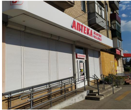
[ Вивіска в м.Павлоград. Матеріали: металевий каркас, композитний лист, с/к плівка, зовнішня підсвітка прожекторами на кронштейнах. ]
