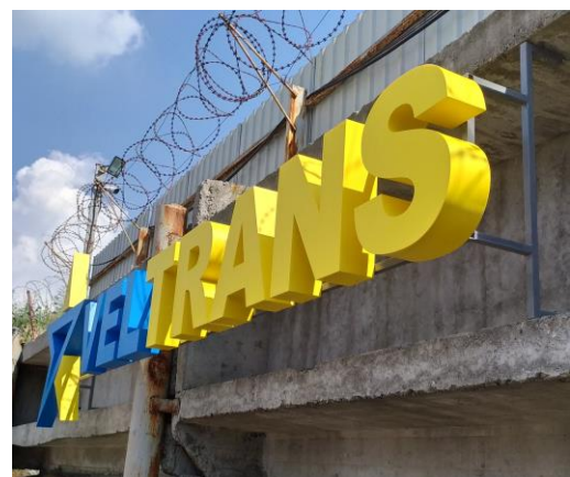
[ Вивіска в м.Дніпро. Матеріали: об'ємні букви з акрилу, ПВХ та с/к плівки, металевий каркас, внутрішня підсвітка світлодіодними кластерами. ]
